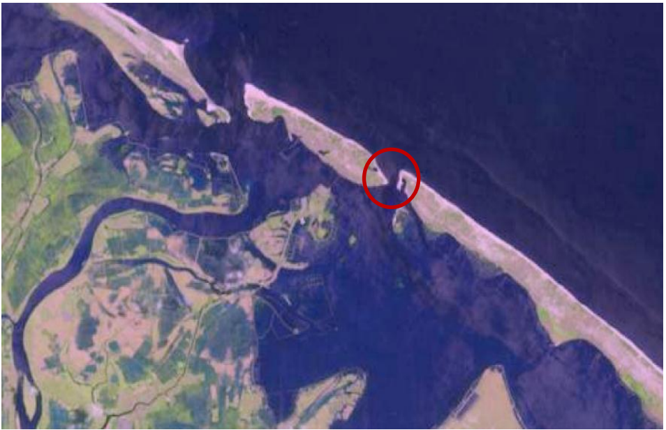
Hình 1: Cồn cát gần thành phố Huế bị xuyên thủng vào năm 2001 sau cơn bão nhiệt đới Eve
